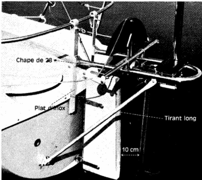
Le bâti doit être à 80/90 cm de la surface de l'eau et l'arbre avec sa pale à 10 cm minimum derrière le safran.
