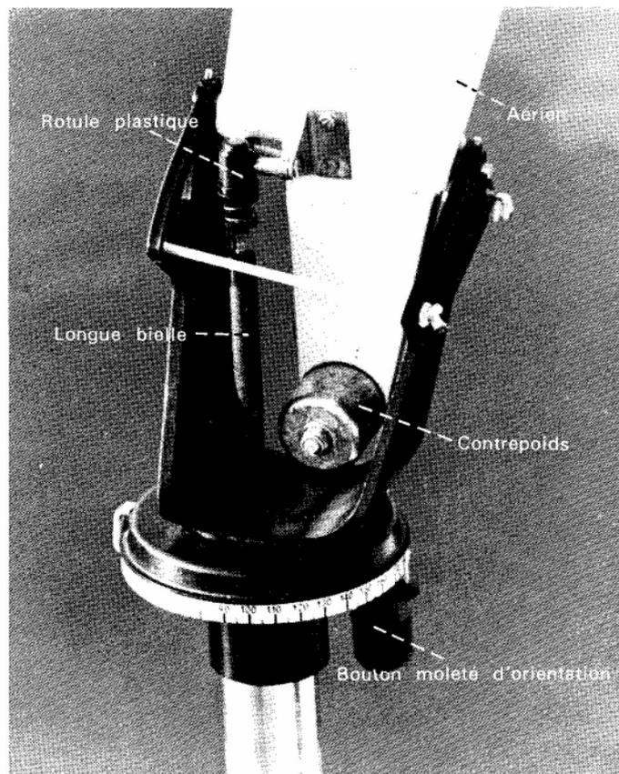
Verrouiller l'aérien, la biellette inox a rotule de la base du mât doit être verticale ou légèrement inclinée vers la gauche (photo page 19), pour que son débattement soit le même des deux bords.
